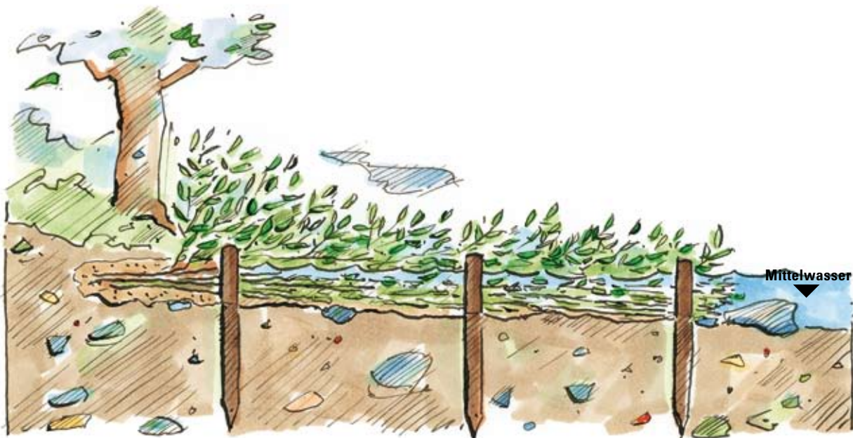
Abb. 4.20: Faschinenbuhne, Entwicklung nach drei Monaten
