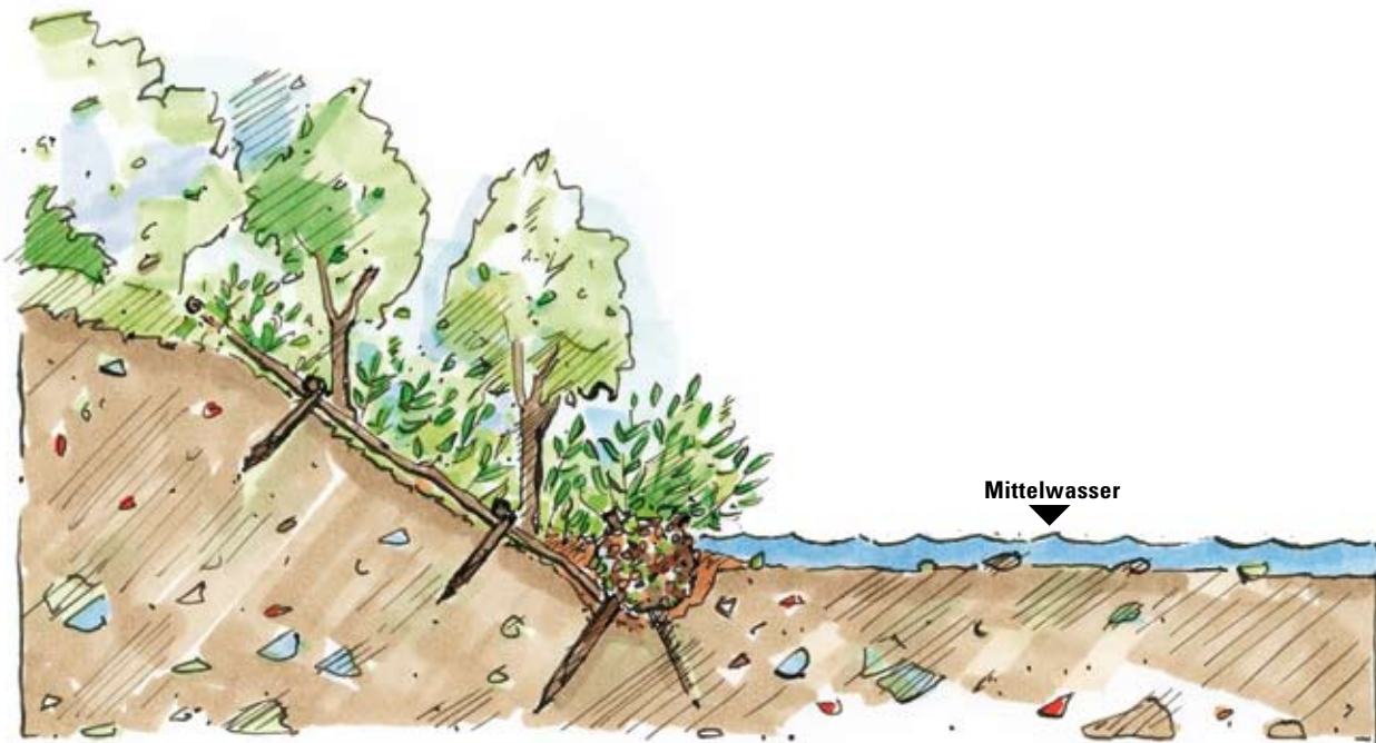
Abb. 4.9: Spreitlage in Kombination mit Faschinen-Fußsicherung, Entwicklung nach drei Monaten
