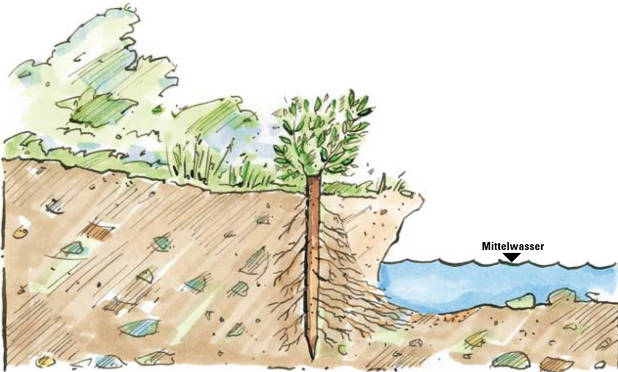
Abb. 4.30: Setzstange, Entwicklung nach drei Monaten
