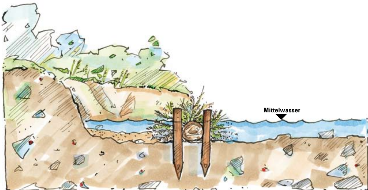
Abb. 4.14: Raubaum, Verlandung nach Abflüssen über Mittelwasser
