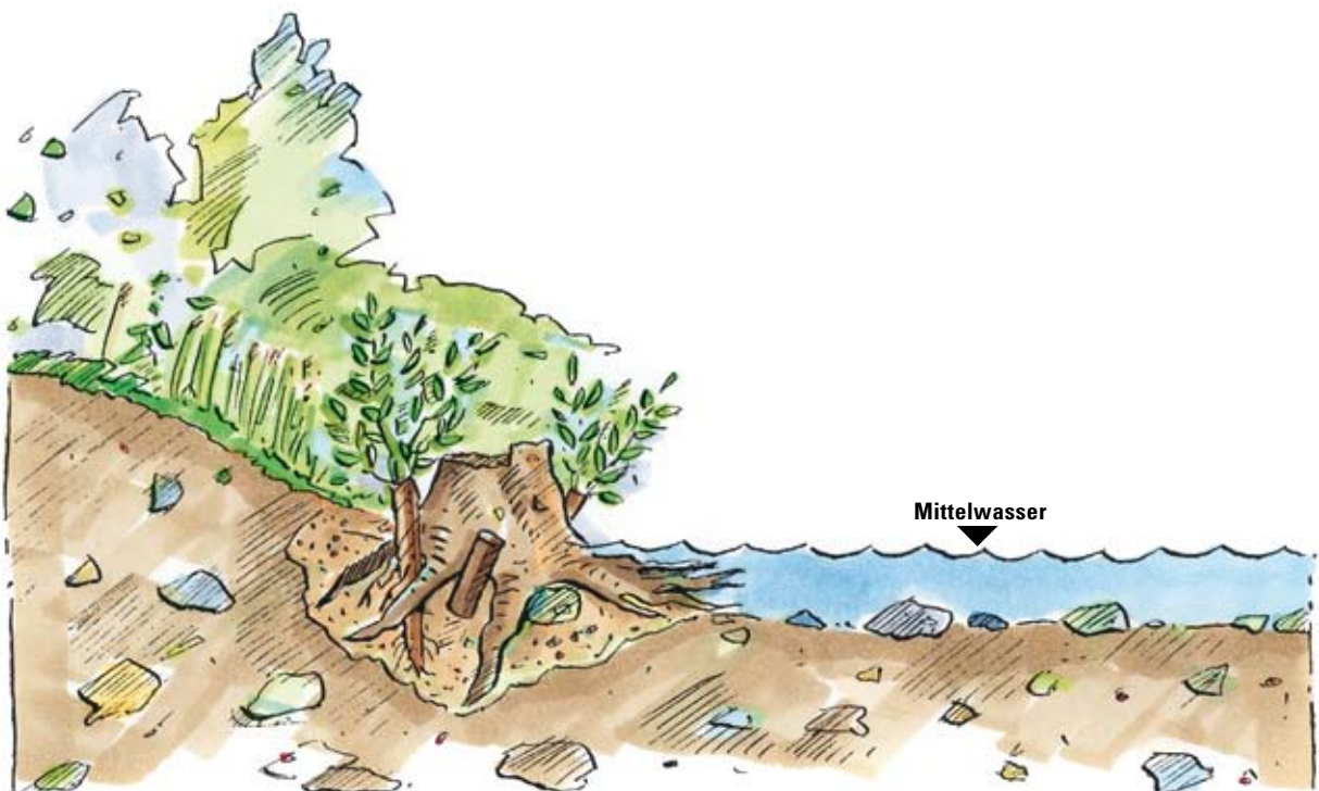
Abb. 4.17: Wurzelstock, Entwicklung nach drei Monaten
