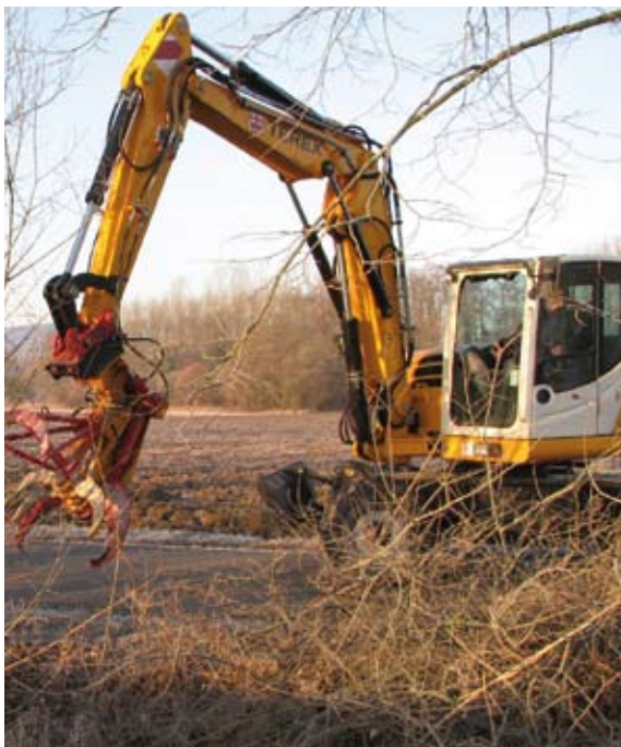
Abb. 3.7: Maschinelle Gewinnung von Weiden mit „Griffy“ am Bagger (Dreisam bei Riegel)
