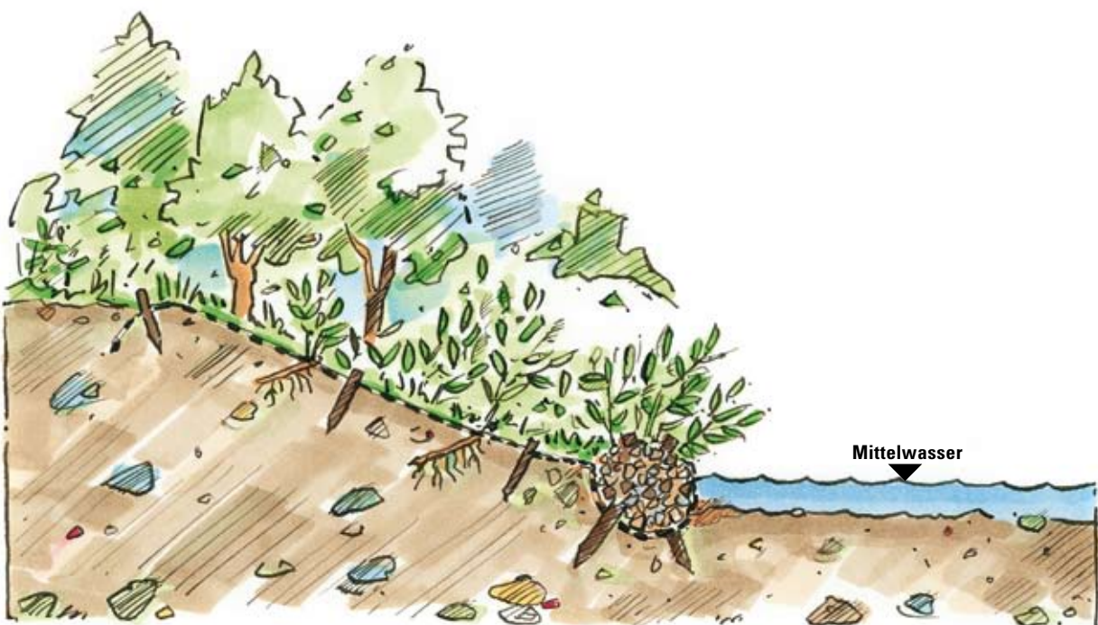
Abb. 4.40: Böschungsschutzmatte in Kombination mit Faschinen-Fußsicherung, Herstellungszustand
